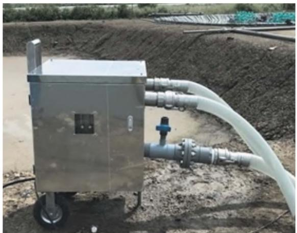
開発したノズルを内蔵したファインバブル発生装置
